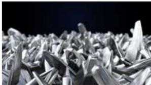
Verschleißt schneller, da einzelne Kristalle aus dem Verbund herausgelöst werden.
