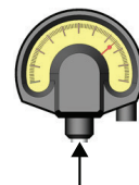
+ 0,025 mm (+ 0.001") über der Führungsleiste
