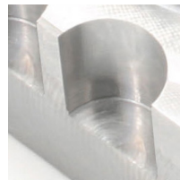
Ausdrehen mit unterbrochenem Schnitt
