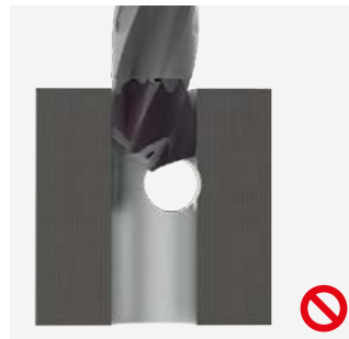
Bohrung außermittig; Querschnitte nicht im Eingriff
