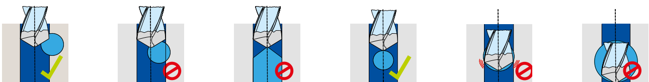
Bohrung außermittig Querschnitte im Eingriff
