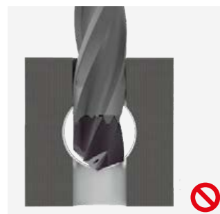
Bohrung mittig und \gg D
