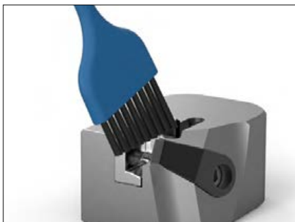
4. TEC-Wendeplatte entnehmen. Wendeplattensitz und TEC-Wendeplatte säubern.
