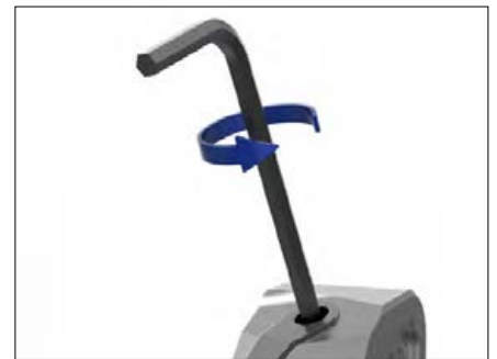
3. Gewindespindel 1,5 Umdrehungen gegen den Uhrzeigersinn drehen.
