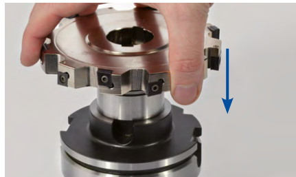
5. Das Werkzeug auf den Aufsteckfräserdorn plan aufsetzen.
