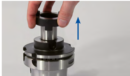
1. Den Mitnehmerring vom Aufsteckfräserdorn nehmen.
