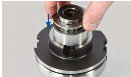
4. Den zweiten Distanzring auf den ersten Distanzring und den Aufsteckfräserdorn aufsetzen.
