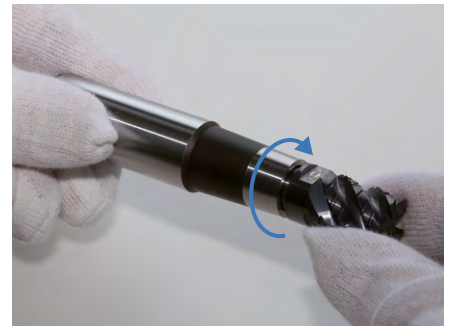
3. Den Wechselfräskopf im Uhrzeigersinn handfest in den Wechselkopfhalter eindrehen. Anschließend den Wechselkopfhalter samt Werkzeug in den Maschinenhalter einspannen.
