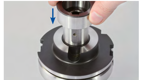
3. Den ersten Distanzring auf den Aufsteckfräserdorn aufsetzen.
