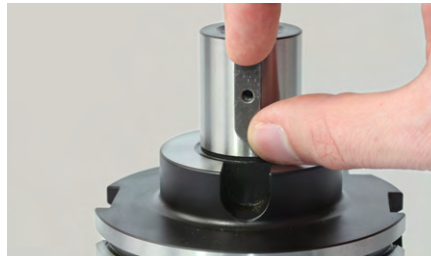
2. Die Passfeder am Aufsteckfräserdorn einsetzen.
