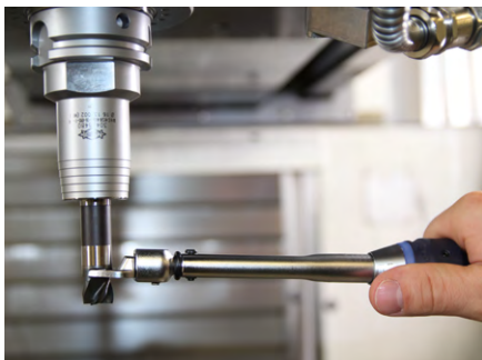
4. Den Drehmomentschlüssel möglichst horizontal am Wechselfräskopf anlegen und dabei nicht mit der Schlüsselfläche verkanten.
