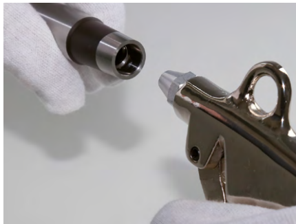
2. Den Wechselkopfhalter an Kegel, Gewinde und Planfläche mit Druckluft und Tuch reinigen.
