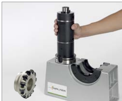
11. Einlegen der zusammengebauten Werkzeugaufnahme in den Steilkegel
