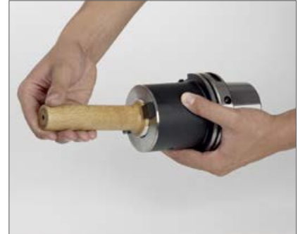
3. Reinigen des Innenkegels und der Plananlage
