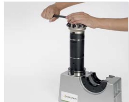
12. Einbau und Festziehen des Werkzeugs
