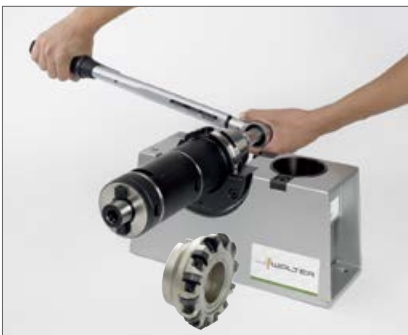
10. Festziehen mit einem Drehmomentschlüssel
