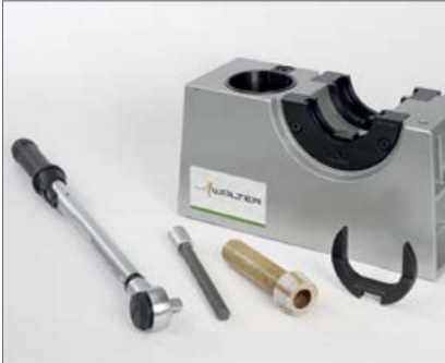
1. Montageeinrichtung mit Zubehör
