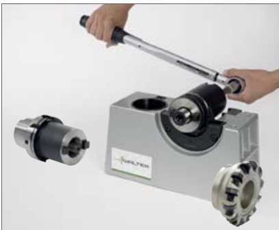
7. Festziehen mit einem Drehmomentschlüssel
