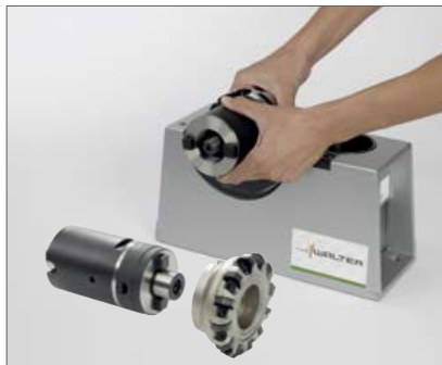
8. Einlegen des Masters in den dazugehörigen Flansch
