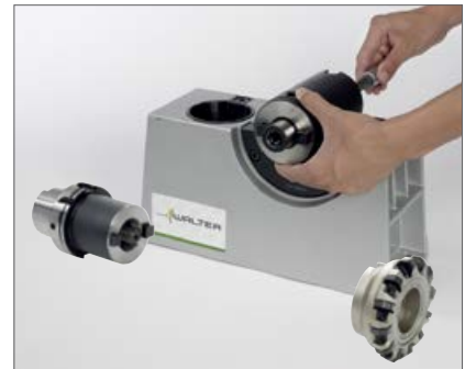
6. Zusammenschrauben der Verlängerung und der Fräsaufnahme mittels Steckschlüssel von Hand
