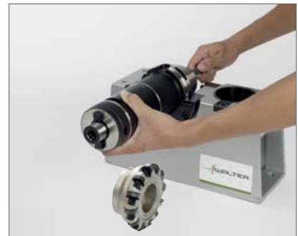
9. Zusammenschrauben der NC-Tool-Elemente mit dem Master
