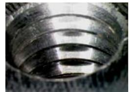
Gewindebohrer mit DLC-Schicht in AISi7
