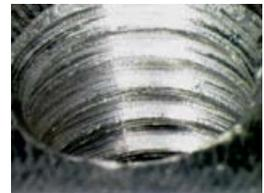
Gewindebohrer mit TiCN-Schicht in AISi7
