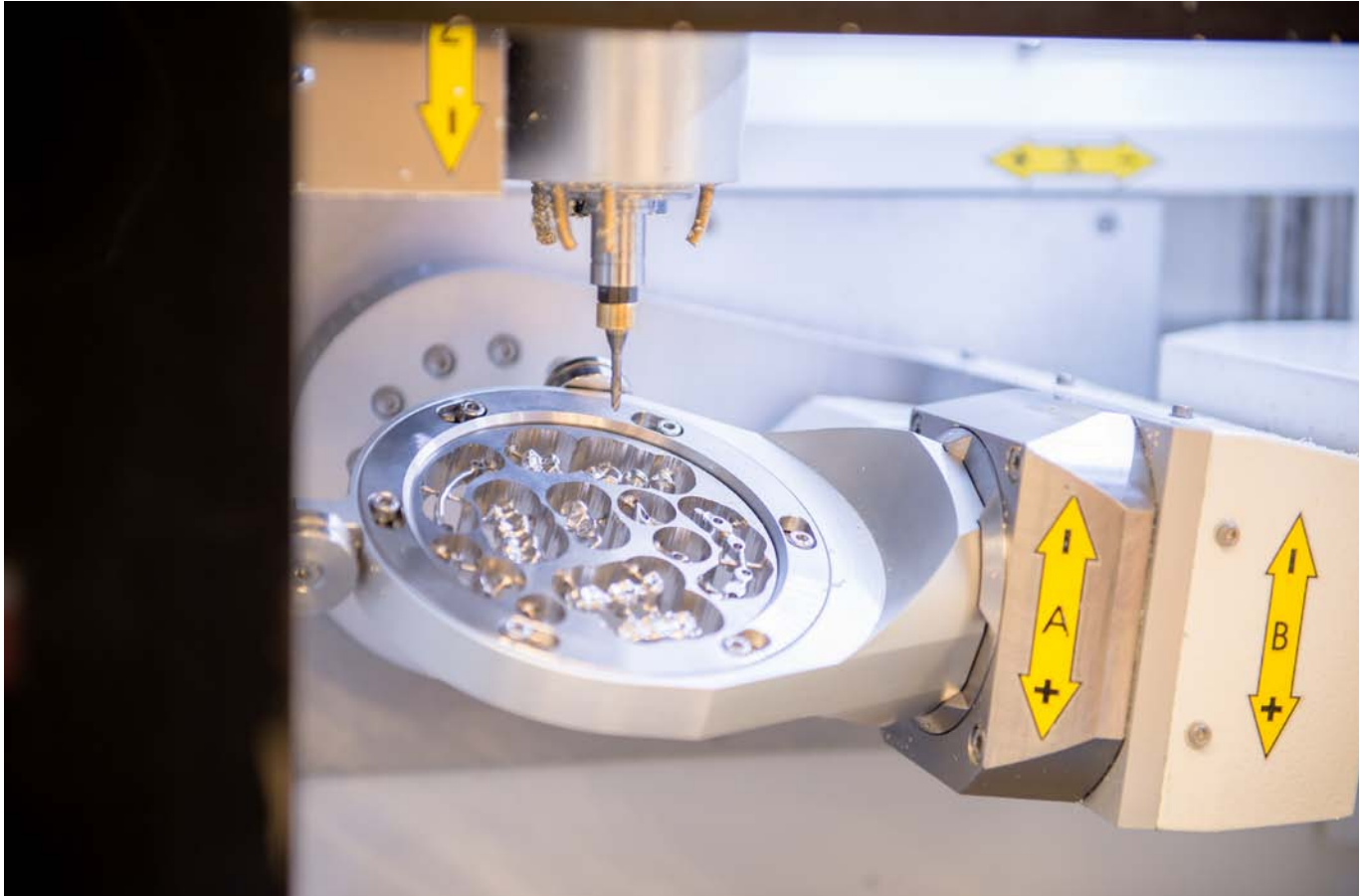
Vollautomatisiertes Beladen und Spannen von Ronden bei der Herstellung von Zahnimplantaten.
