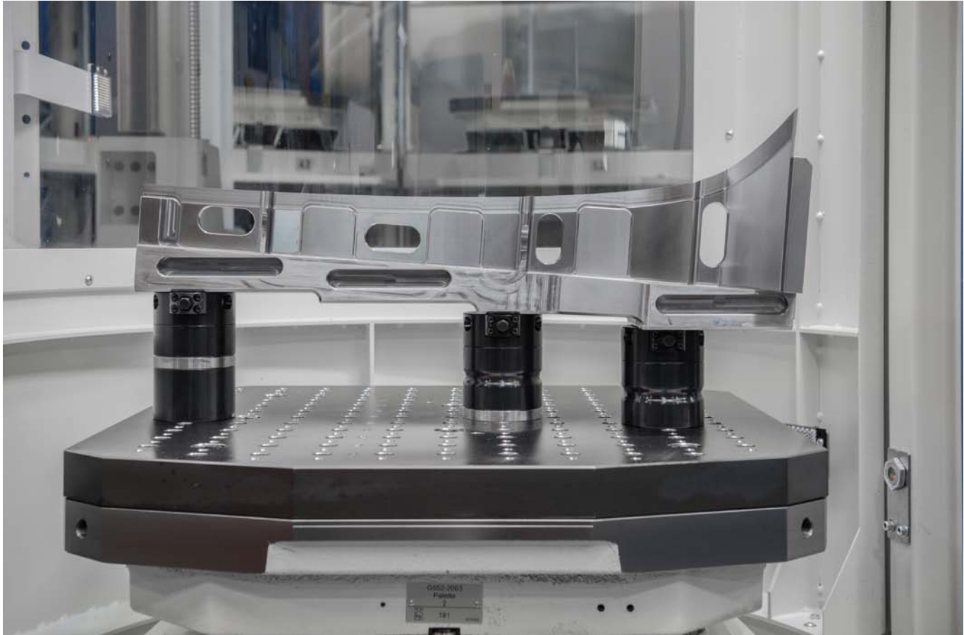
Modulares mechanisches Nullpunktspannsystem im Werkzeug- und Formenbau. Die benötigten unterschiedlichen Spannhöhen können durch das standardisierte Baukastensystem einfach angepasst werden.
