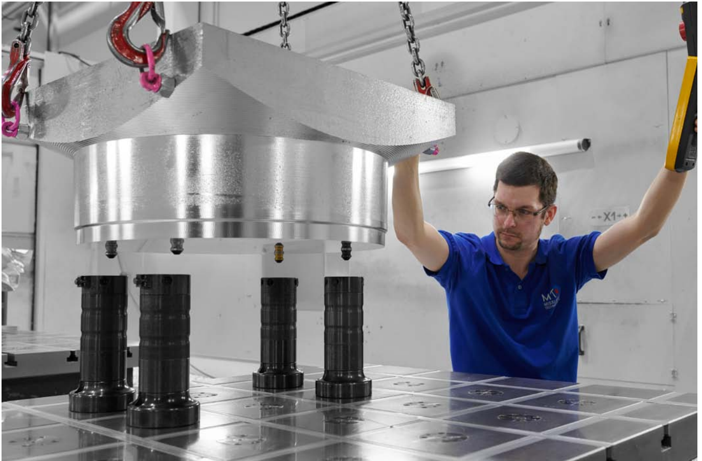
Rüstzeiten mit AMF-Nullpunktspanntechnik minimieren: Mit wenigen Handgriffen ist das Werkstück für die Fünfseitenbearbeitung gespannt.
