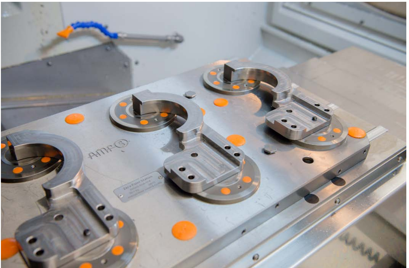
8-fach-Spannstation zur Aufnahme verschiedenster Standard-Spannmittel bzw. Werkstückdirektspannung.
