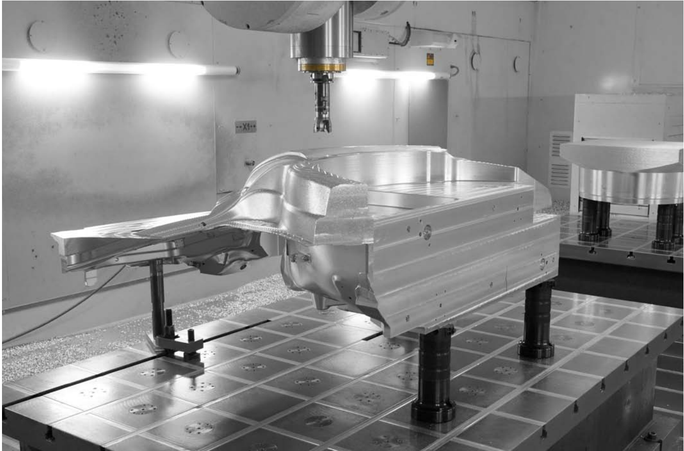
Werkstückdirektspannung von Aluminum-Großteilen. Nullpunktspannmodule im Aufspanntisch in Verbindung mit Aufbau- und Zwischenelementen des modularen Nullpunktspannsystem ermöglichen eine flexible Aufspannung.
