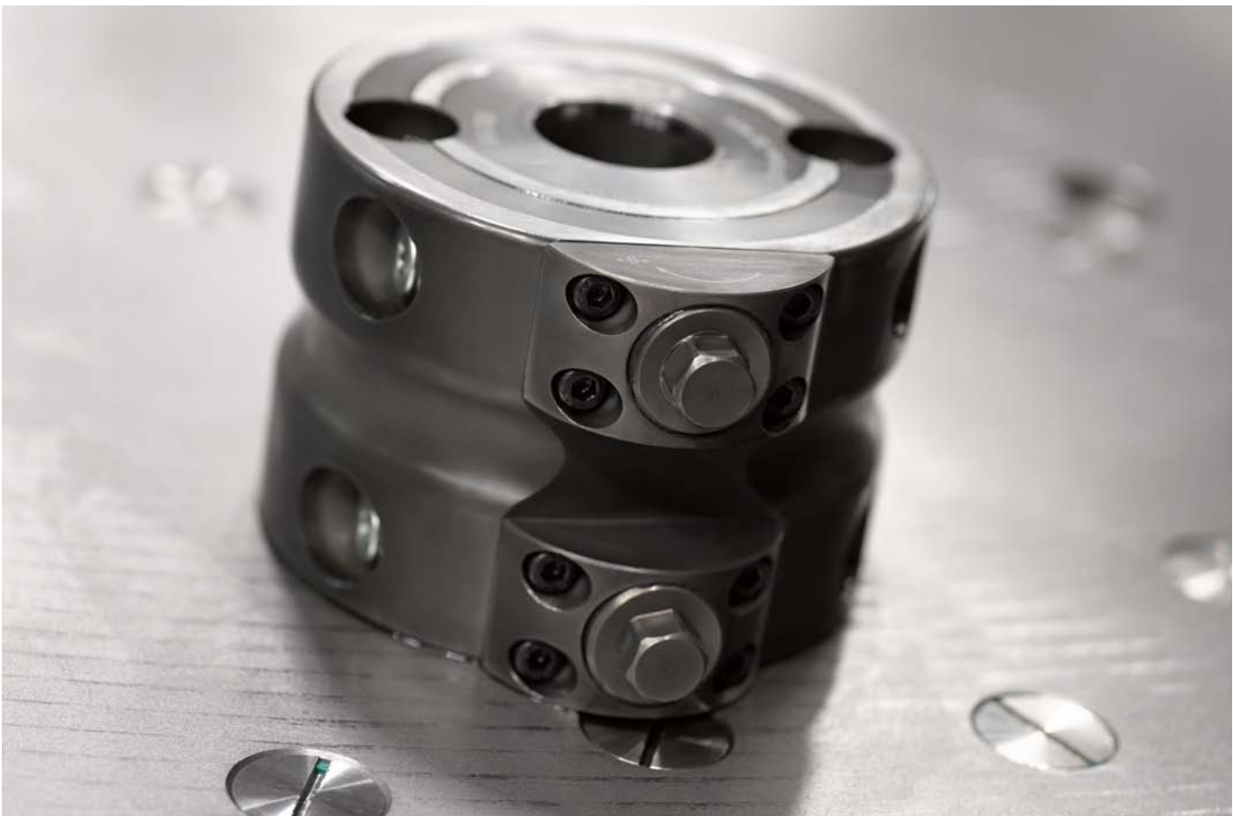
Bauteildirektspannung mittels mechanischer Doppel-Spannmodule.
