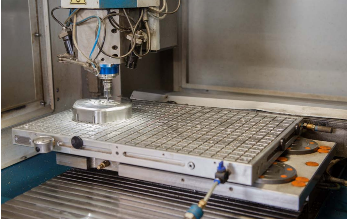
Kombinierte Anwendung von Vakuum- und Nullpunktspanntechnik. Die Vakuumspannplatte ist ab Werk mit Spannbolzenaufnahmen ausgestattet.
