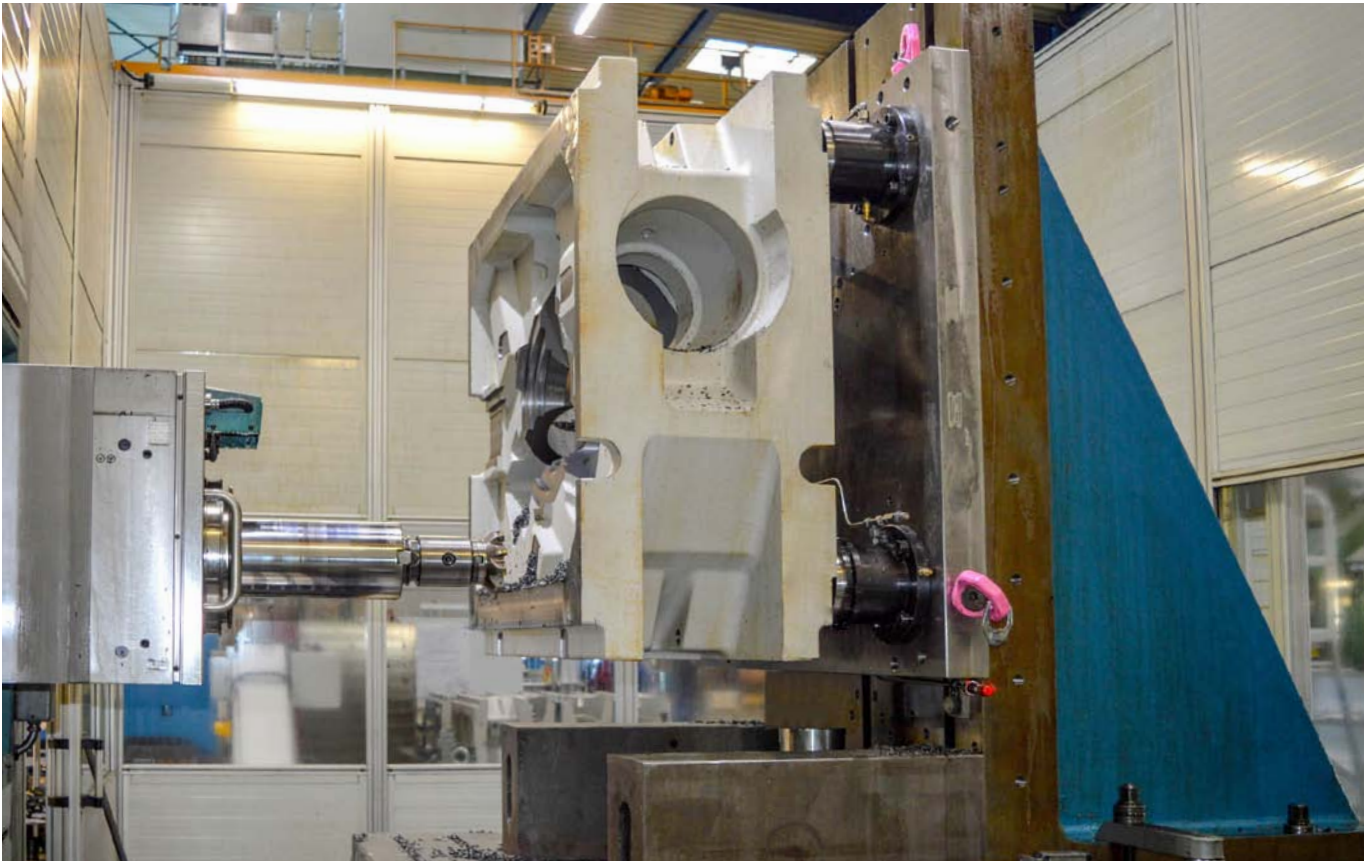
Werkstückdirektspannung auf einem Horizontal-Bearbeitungszentrum. Zwei der vier Nullpunktspannkonsolen sind in der Höhe einstellbar. Dadurch können Werkstücktoleranzen kompensiert werden.
